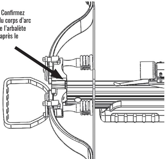
**Étape 4 :** Insérez une vis à tête plate 5/16-18 x 2,25" à travers l'ensemble du corps de l'arc et vissez-la dans l'écrou à portée cylindrique, vous devrez peut-être tourner légèrement l'écrou à portée cylindrique pour parfaire l'alignement du filetage et du fastener. Serrez avec une clé allen de 3/16" :
