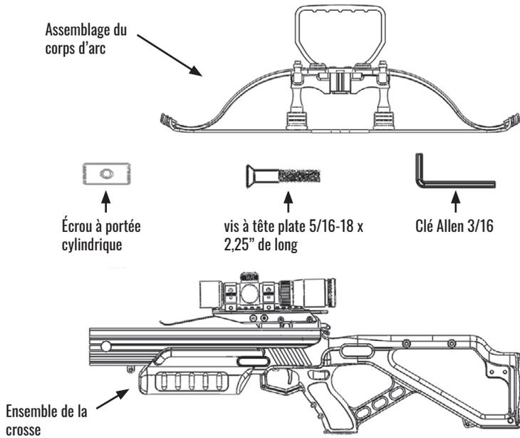
**Étape 2 :** Insérez l'écrou à portée cylindrique dans le trou du cadre de l'arbalète, assurez-vous que l'un des trous taraudés de l'écrou à portée cylindrique est orienté vers l'avant de l'arc, l'écrou à portée cylindrique doit dépasser à part égale des deux côtés du cadre de l'arbalète une fois qu'il est correctement centré :
